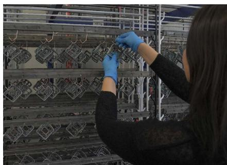
Die Teile werden vorgängig der Lackierung abgedeckt und vorgehängt.
